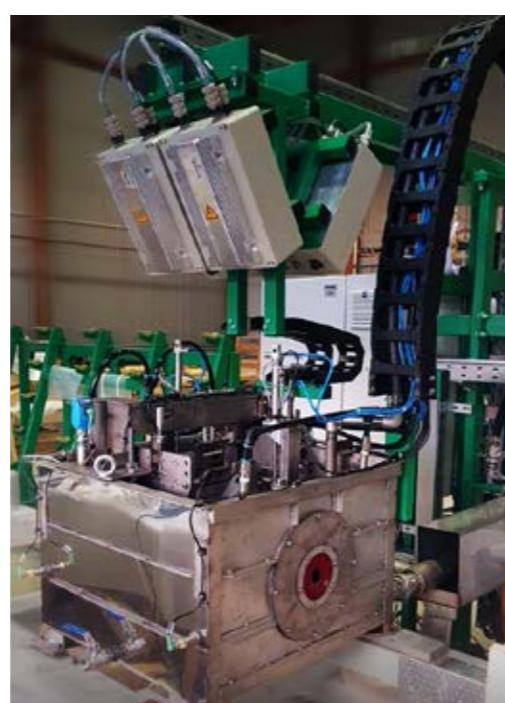
Вне зависимости от конфигурации установки серии NORDISCAN-BB оснащаются различными типами ультразвуковых преобразователей, что существенно расширяет сферы их применения и количество решаемых задач.
